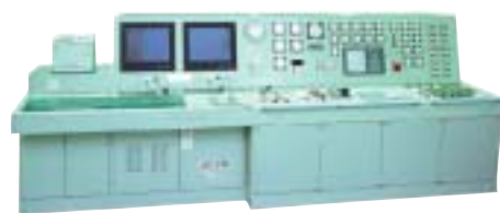
機関制御監視モニタシステム
